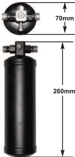
No6 MIO x No6 MIO 1 X 7/16" UNF PORT 1 X RELIEF VALVE PART No: 2700-10008
