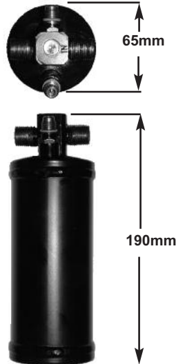
No6 MIO x No6 MIO 1 x 1/4" MF PORT 1 x 3/8" UNF PORT PART No: 2700-20060
